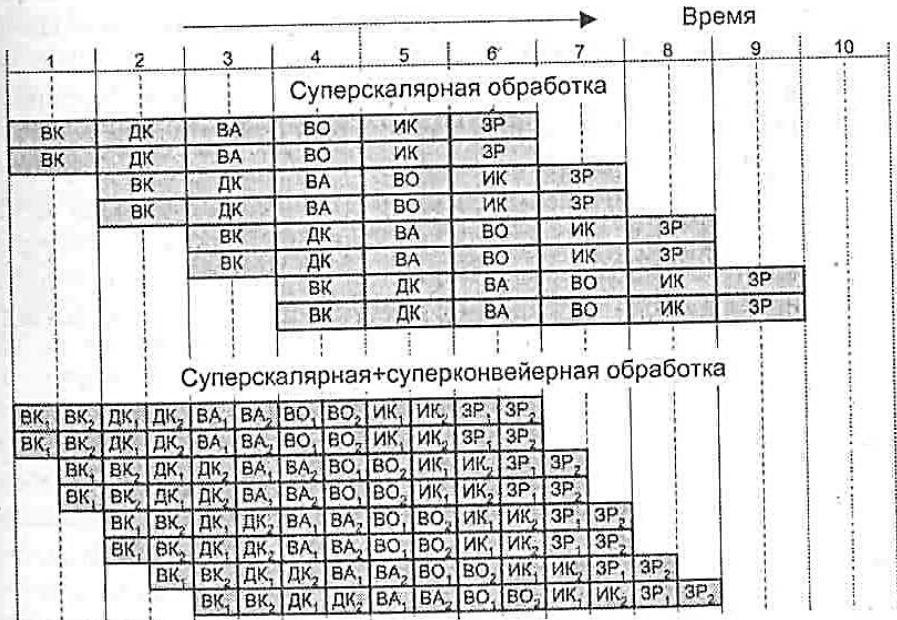
Рис. 7.12. Сравнение эффективности, стандартной и совмещенной схем суперскалярных вычислений
