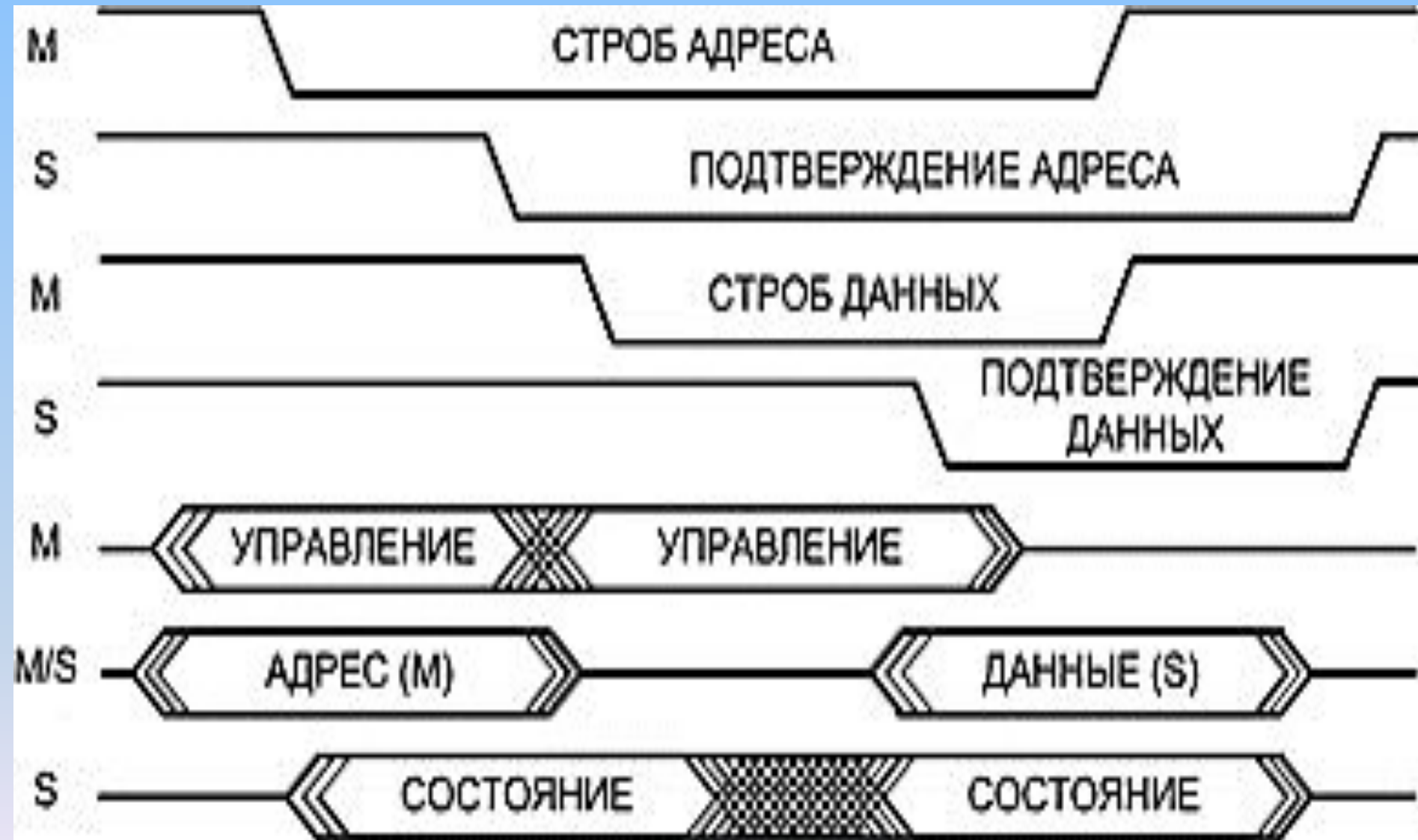
Рис. 5.15. Чтение на асинхронной шине
