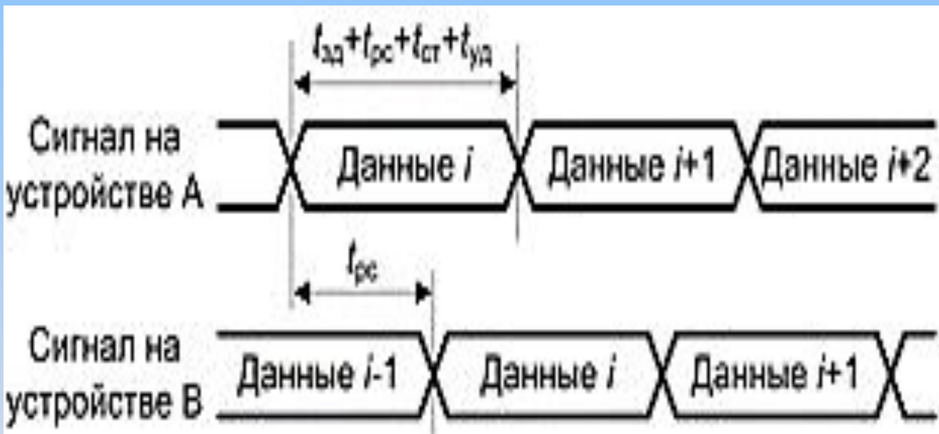
Рис. 5.17. Конвейеризация транзакций чтения
