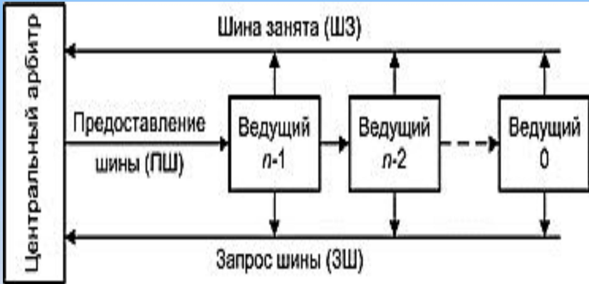
**Рис. 5.13. Централизованный последовательный арбитраж с цепочкой для сигнала предоставления шины**
