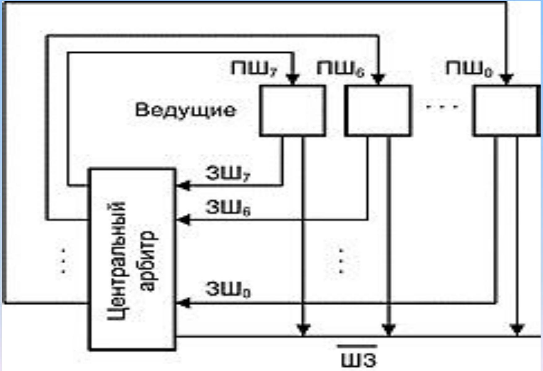
Рис. 5.12. Централизованный параллельный арбитраж
