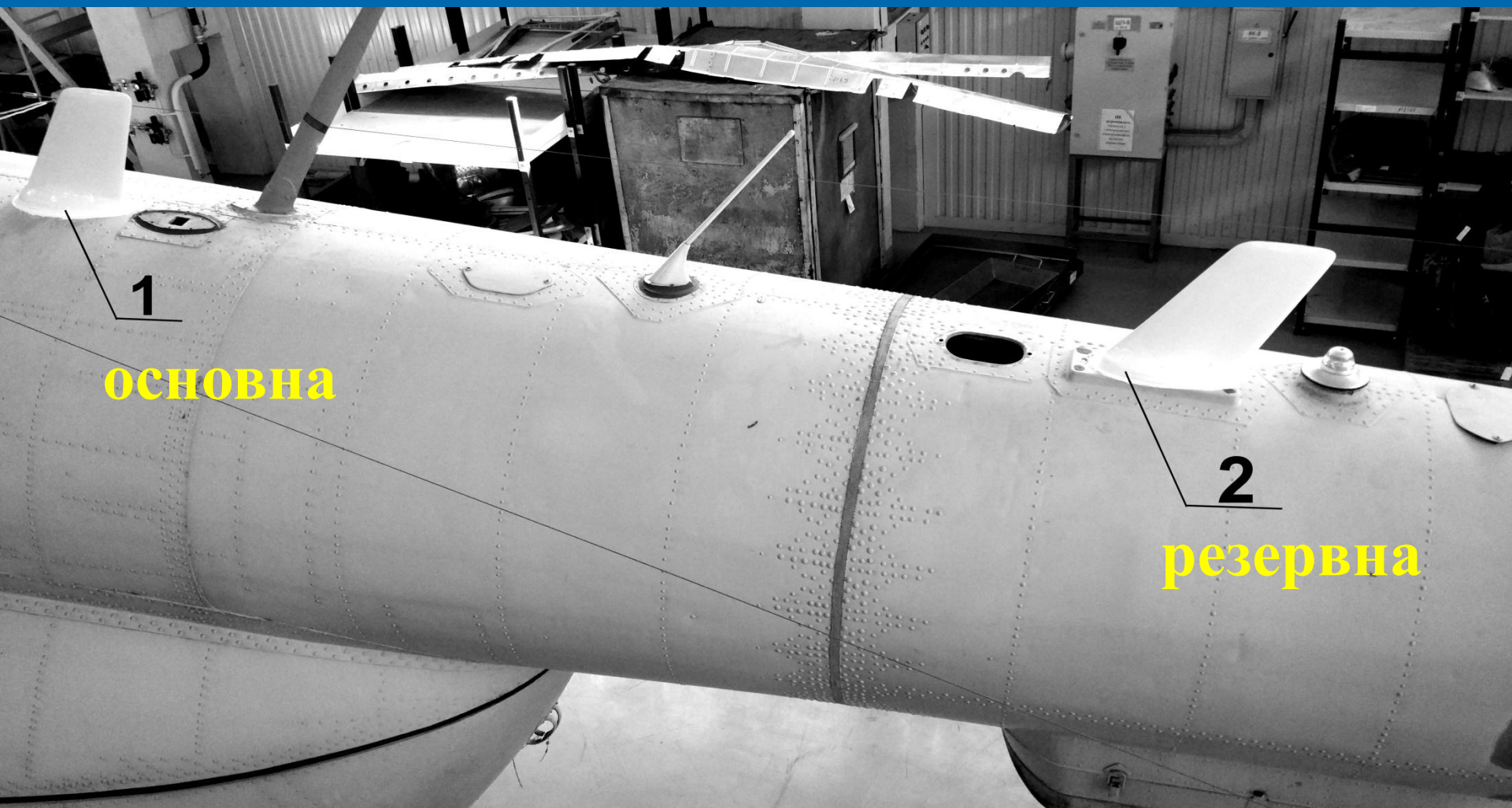
Рисунок 1. Антени Сі-108 основної та резервної радіостанції ВЕСКЕР RT6201/RSCU6201
