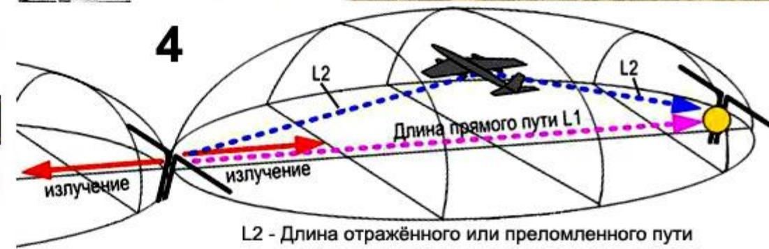
● Направление на объект радиолокация в РЛС с механически управляемой антенной определяют по угловому её положению, при котором величина принимаемого сигнала достигает максимума; в РЛС с электронно управляемым лучом вместо углового положения антенны измеряют угловое положение луча относительно нормали к раскрытию антенны.
