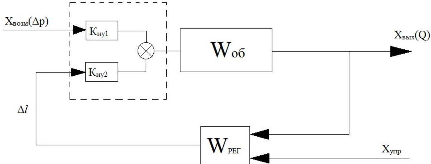
Передаточная функция объекта управления- одноёмкостное звено с запаздыванием
