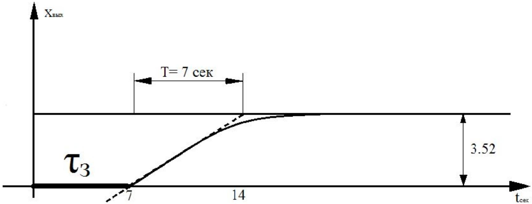
Теоретическая кривая разгона объекта регулирования.
