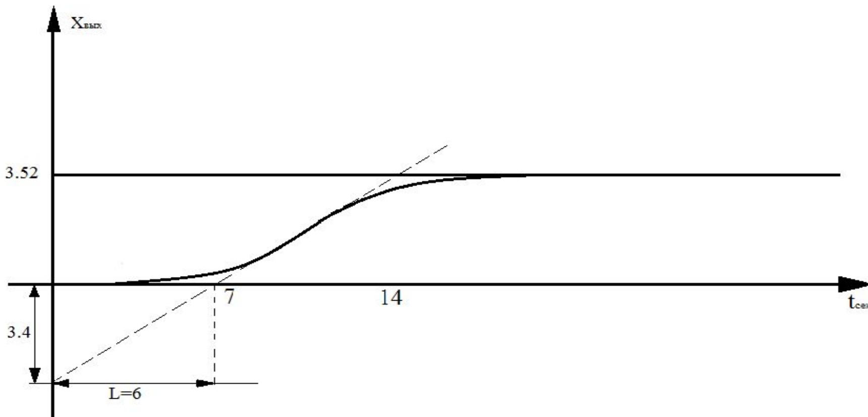
Апроксимированная кривая разгона объекта регулирования
