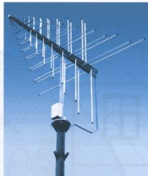
Рис. 3. Комплекс перехвата побочных электромагнитных излучений СВТ: а) специальное приёмное устройство PKI 2715 (дальность перехвата ПЭМИ от 10 до 50 м); б) широкополосная направленная антенна R&S HL 007 (диапазон частот от 80 МГц до 1,3 ГГц, коэффициент усиления 5-7 дБ)
