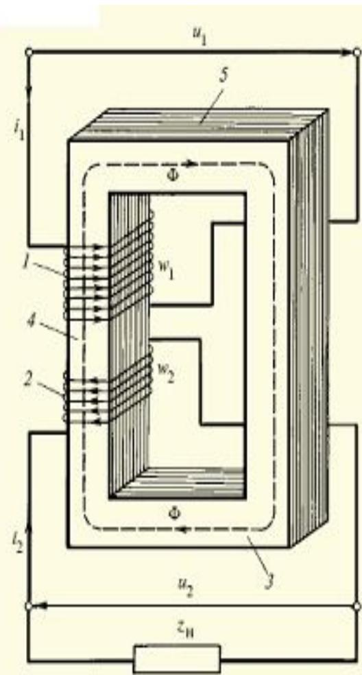
Электромагнитная система однофазного двухобмоточного трансформатора:
