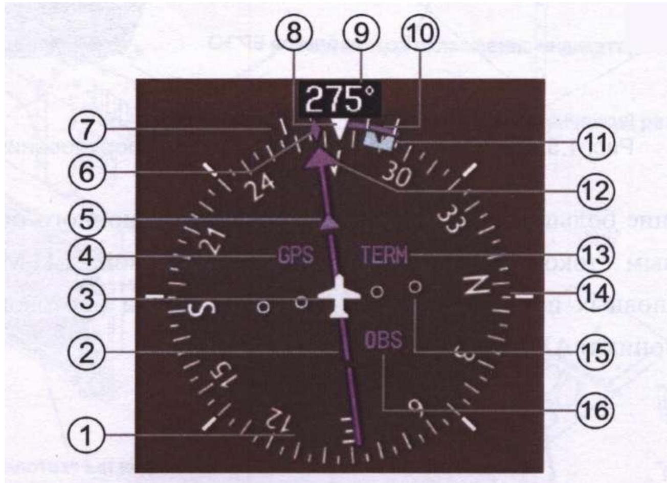
Рис. 3.4. Отображение совмещённого навигационного индикатора на PFD
