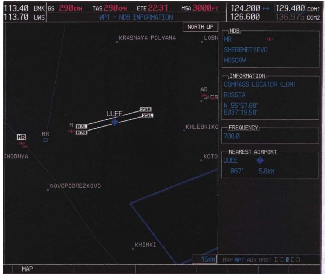
Рис. 3.3.4. Пример отображения информации о приводном радиомаяке NDB
