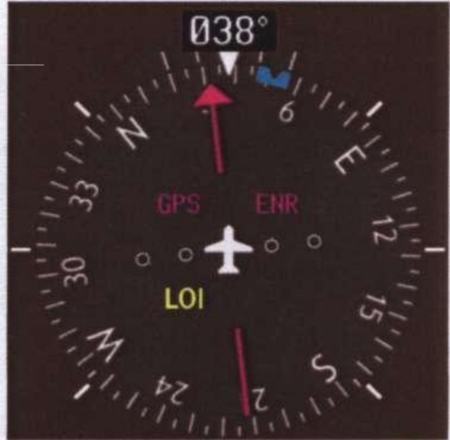
Рис.3.3.3 Сигнализация об отказе функции RAIM на индикаторе HSI
