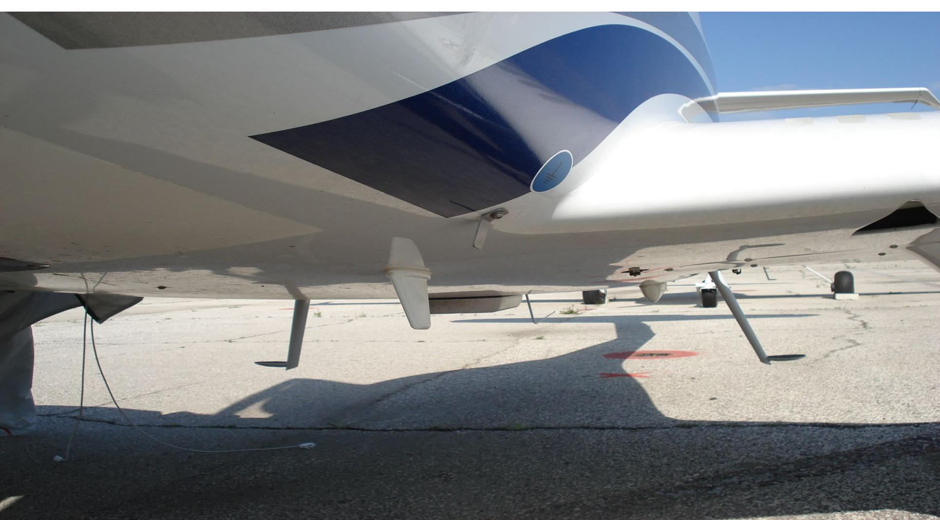
Рис 1.5. Антенна дальномера
