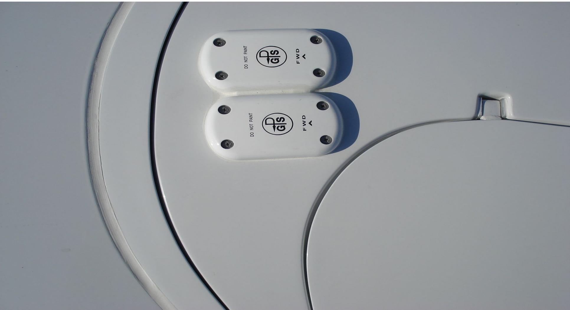
Рис. 1.6. Антенны 2-х комплектов GPS
