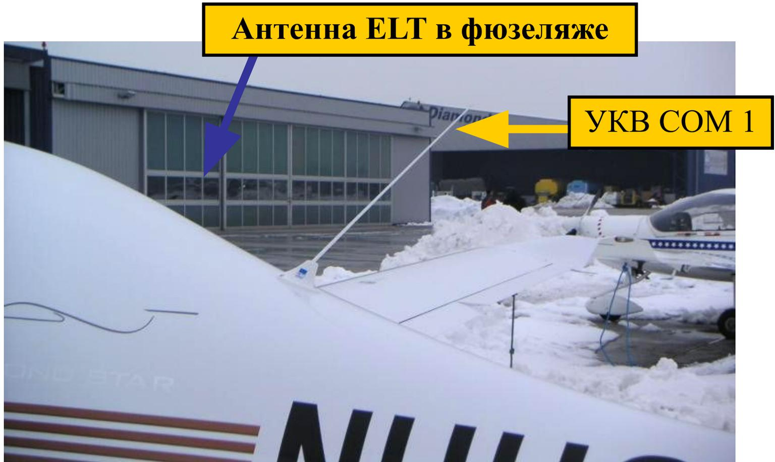
Рис 1.3. Размещение антенн ELT и УКВ COM 1
