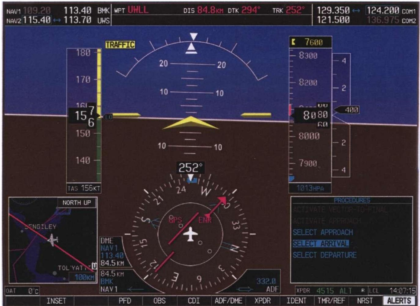
Рис. 3.3.11. Отображение информации в режиме движущейся карты на дисплее PFD
