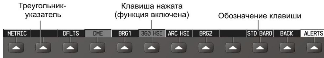
Рис. 3.13. Программируемые клавиши дисплея
