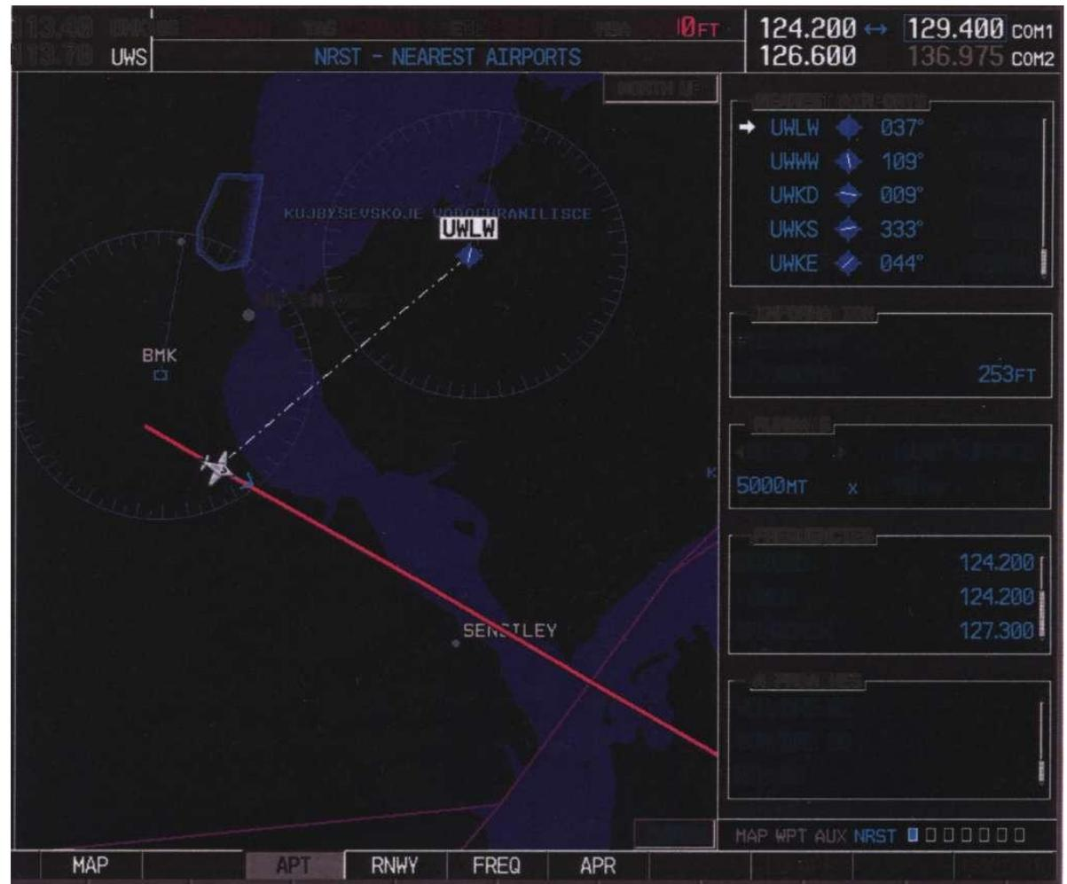
Рис. 3.3.5. Отображение информации о ближайших аэродромах на дисплее MFD
