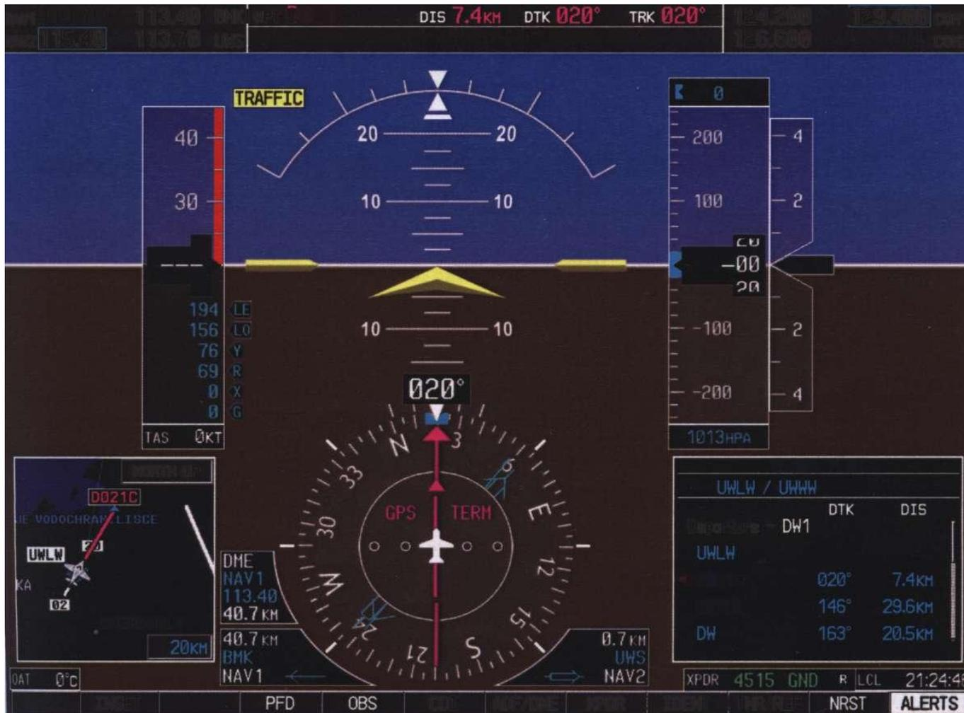
Рис. 3.3.12. Отображение окна активного флайт – плана на дисплее PFD
