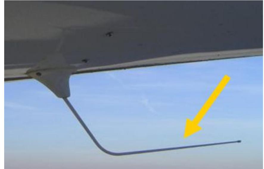
Рис. 2.2. Антенны радиостанций COM 1 и COM 2
