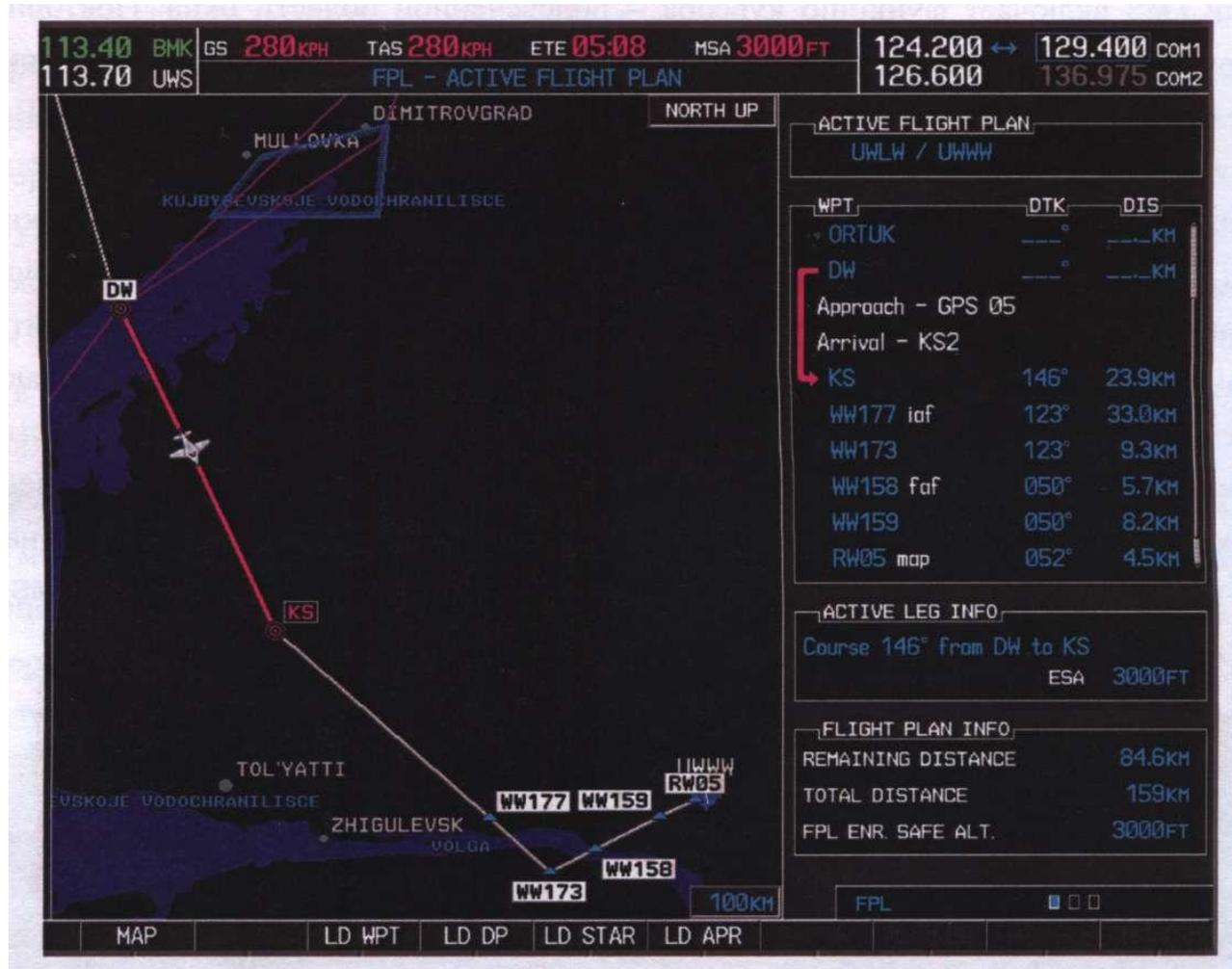
Рис.3.3.13. Отображение активного флайт-плана на дисплее MFD
