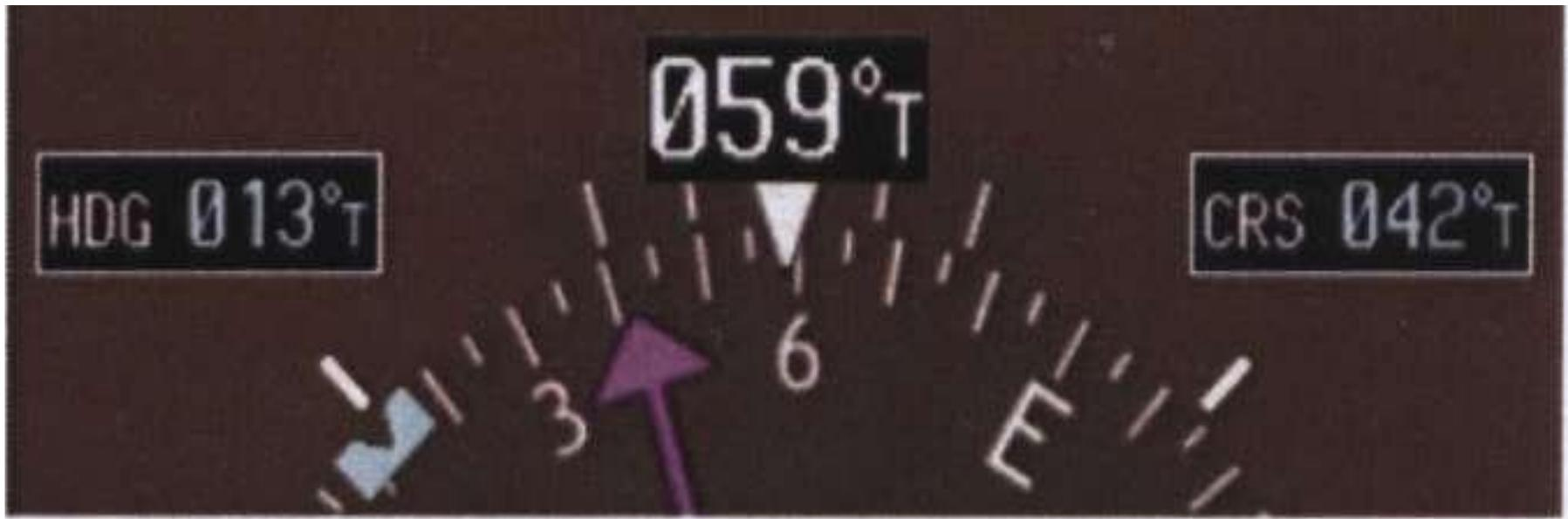
Рис.3.10. Индикация угловых параметров, отсчитанных относительно истинного меридиана
