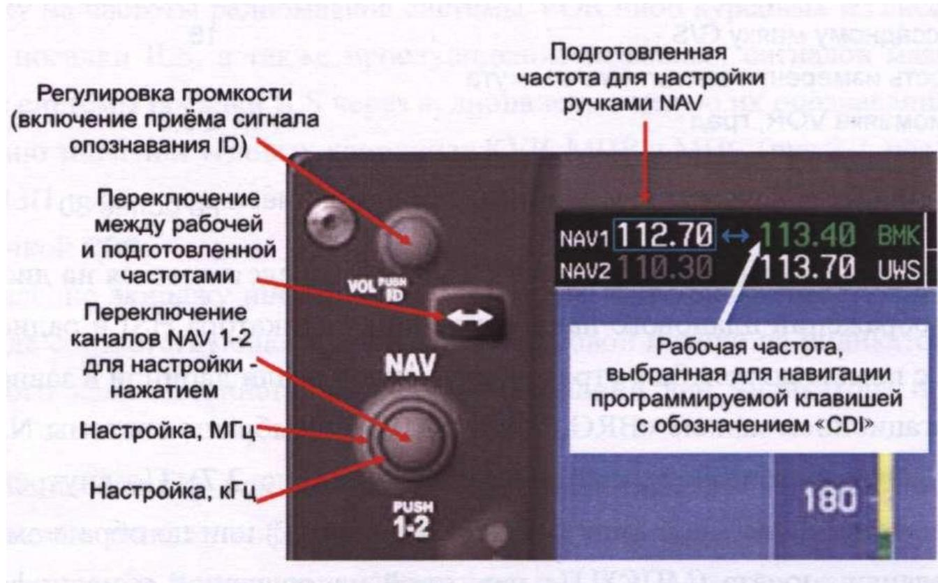
Рис. 3.2.4. Органы управления и индикации настройки систем NAV 1 и NAV 2
