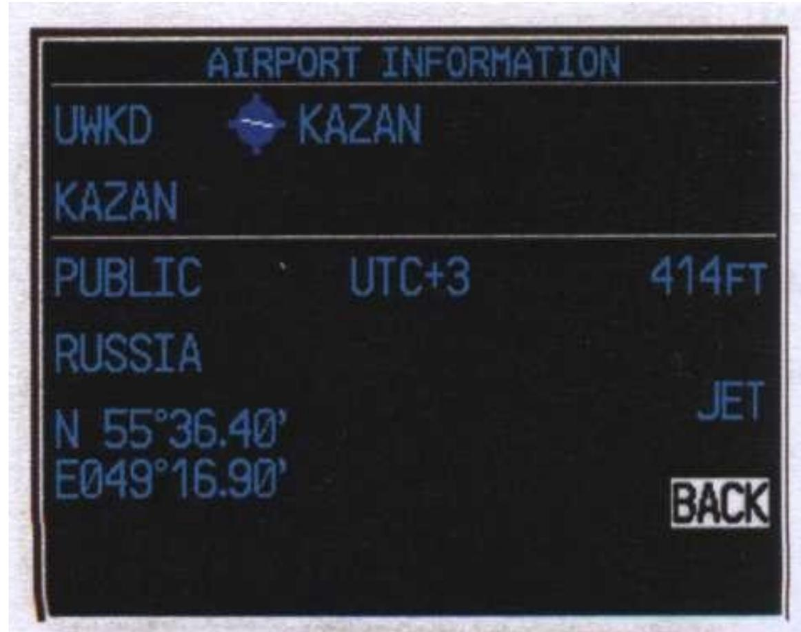
рис. 3.3.7. Представление детализированной информации о выбранном аэродроме UWKD
