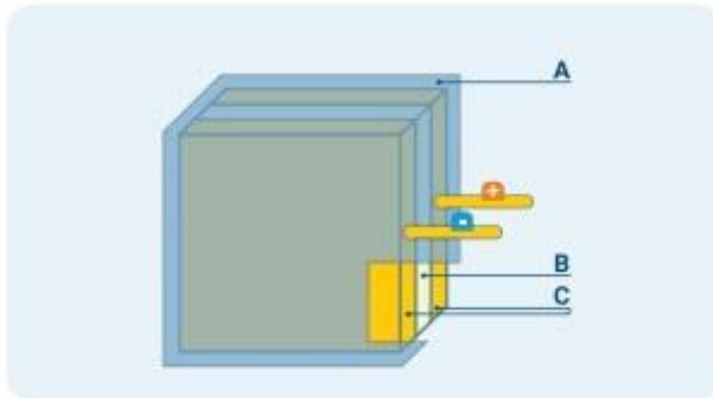
Устройство конденсатора. А – корпус, В – диэлектрик, С – токопроводящие обкладки
