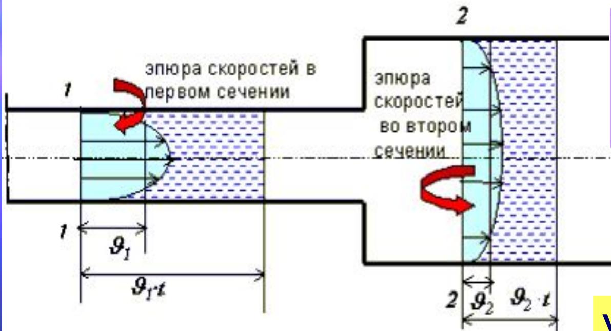
Жидкость несжимаема и в ней невозможно образование пустот. Это условие **сплошности** или **неразрывности** движения
