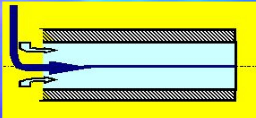
Струйка краски параллельна оси трубы. Слои жидкости не перемешиваются. **Ламинарное движение** (от латинского *lamina* – слой)
