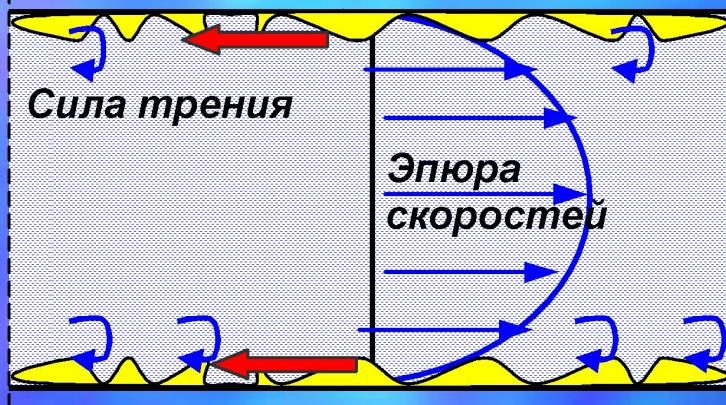
Энергия тратится на работу по преодолению силы трения и на вихреобразование при обтекании микронеровностей стенки турбулентным потоком
