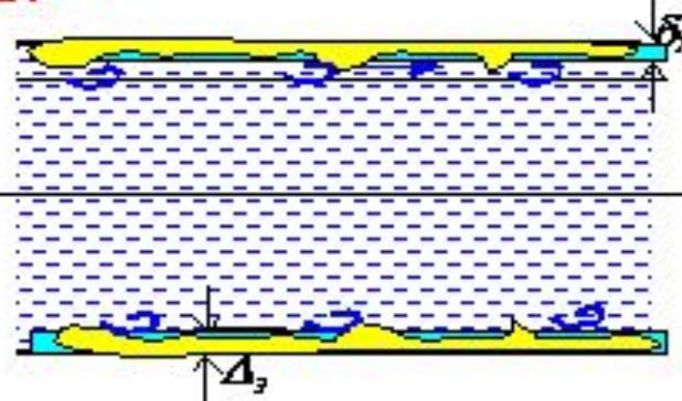
Бугорки шероховатости выступают в турбулентное ядро, с них срываются вихри. А это дополнительное сопротивление
