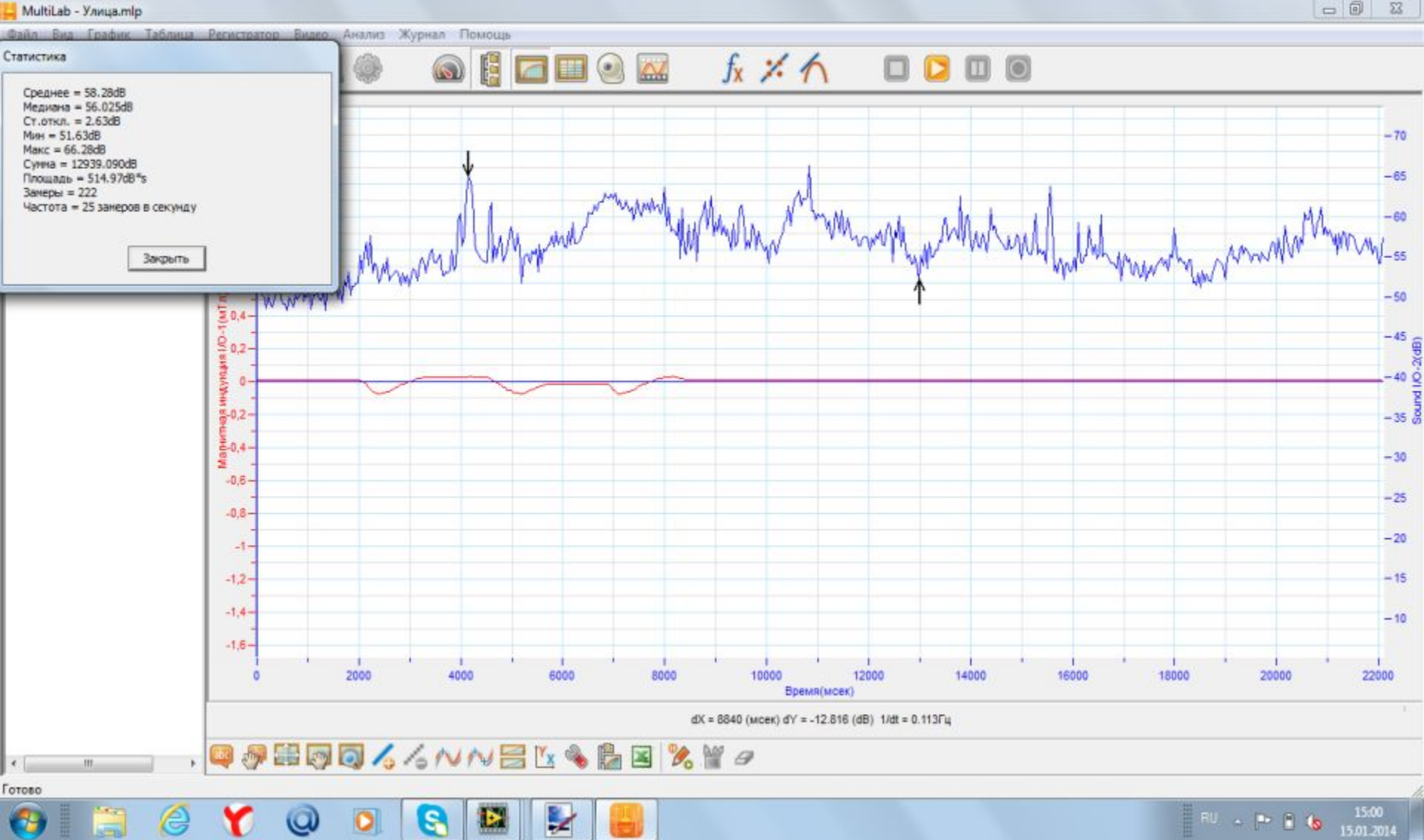
● График 1. Измерение уровня шума и индукции магнитного поля на улице, во время проезда легковых автомобилей
