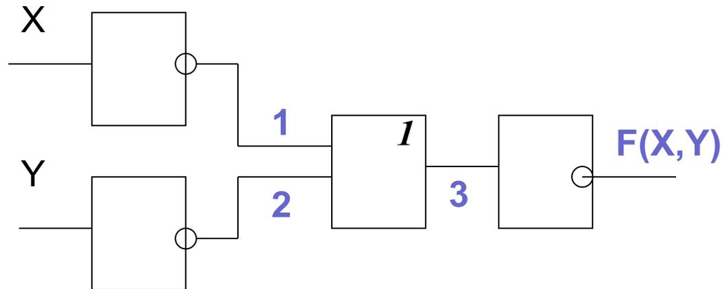
Выход 1 –  $\neg X$ ,    Выход 2 –  $\neg Y$ ,    Выход 3 –  $\neg X \vee \neg Y$ ,
