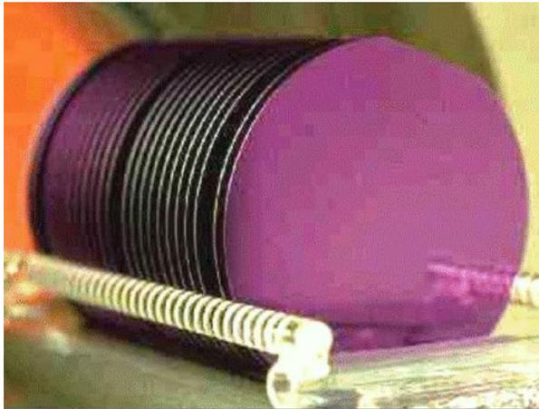
**Параллельное (“групповое”) изготовление большего количества одинаковых устройств**
