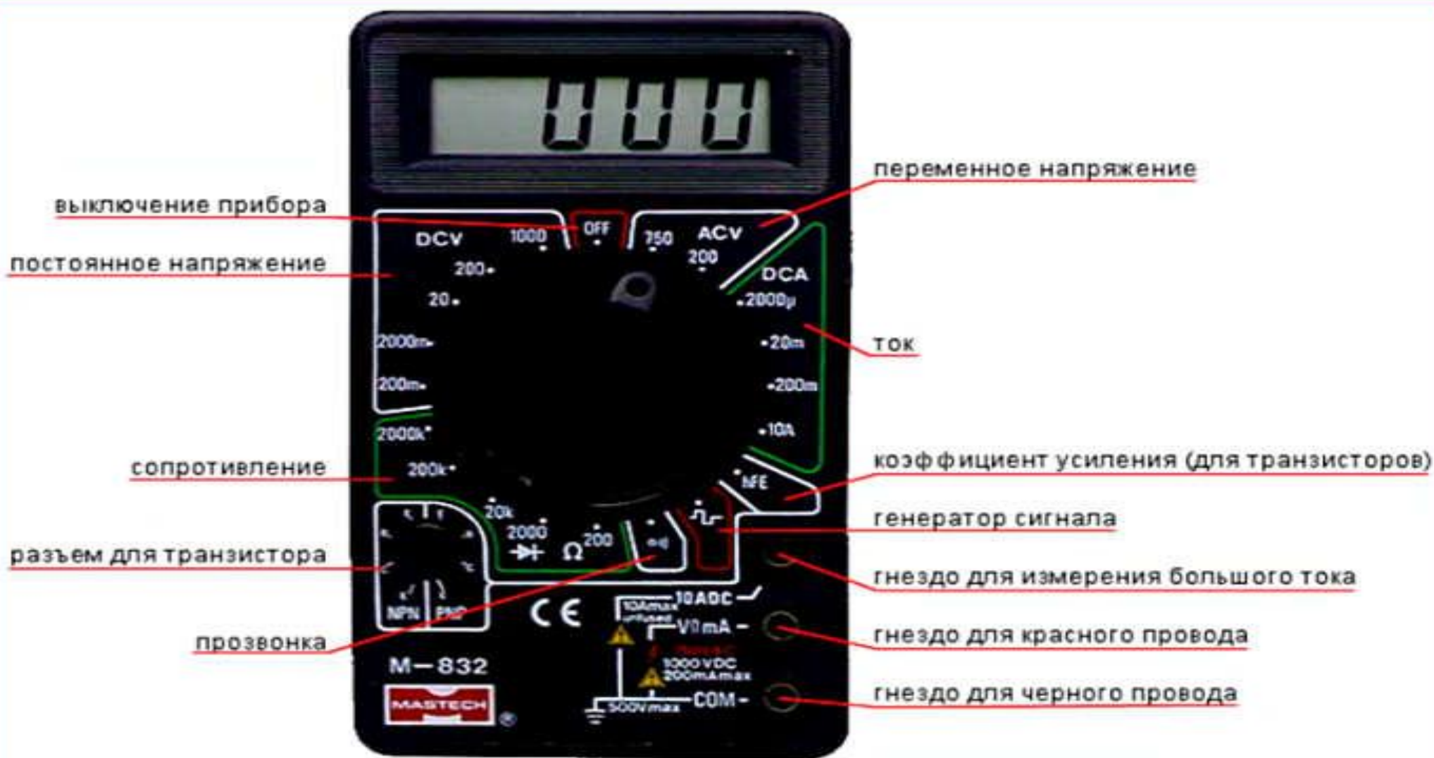
Рис. 1. Внешний вид простого цифрового мультиметра с описанием возможностей измерения.
