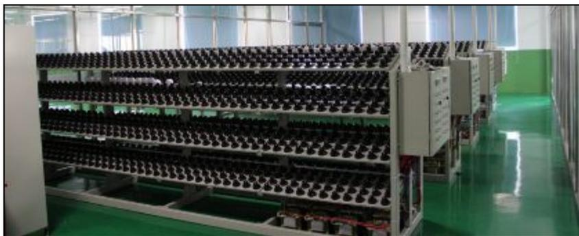
Испытательная линия для проверки работы ламп при разных режимах электропитания (так называемая aging line)
