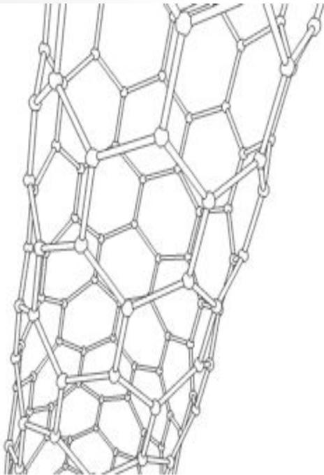
Углеродная нанотрубка (англ. carbon nanotube) – цилиндрическая молекула, состоящая из одних лишь атомов углерода. Имеет диаметр около 1 нанометра и длину от одного до сотен микрометров. Внешне выглядит как свернутая в цилиндр графитовая плоскость. Впервые обнаружена Сумио Ииджимой (корпорация NEC) в 1991 г. как побочный продукт синтеза фуллерена C<sub>60</sub>.
