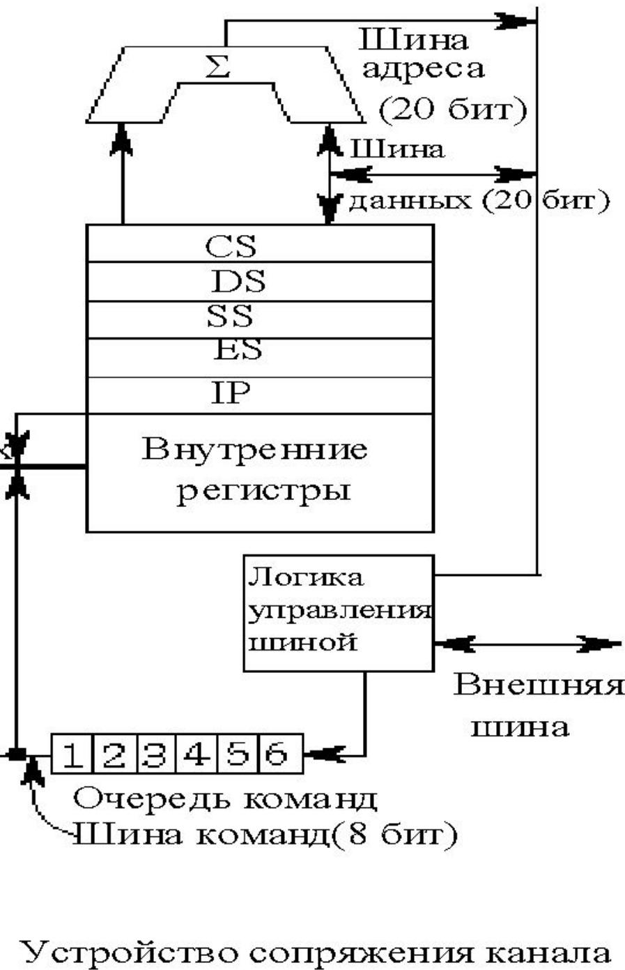
Устройство сопряжения канала
