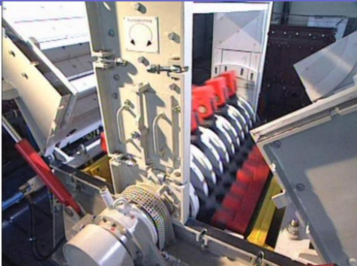
Диаметр/ширина ротора 1/1,2 м; крупность кусков 0...6,3 мм
