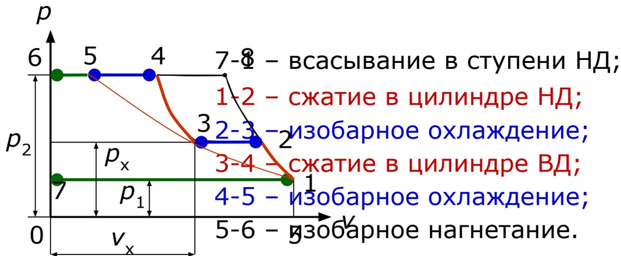
Из рисунка видно, что по сравнению со сжатием 1-2-8 в 1-ступенчатом компрессоре в 2-ступенчатом получается выигрыш в работе сжатия на величину заштрихованной площадки 2-3-4-8-2.
