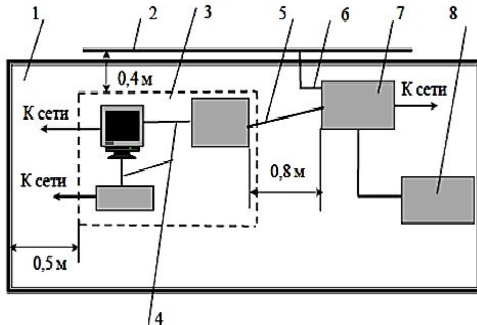
3.7. При испытаниях проводят измерение квазипикового несимметричного напряжения ПЭМИН. За результат измерений на каждой частоте принимают наибольшее из значений, полученных для двух проводов.
