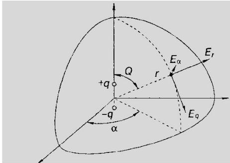
Рис. 6. Элементарный электрический излучатель
