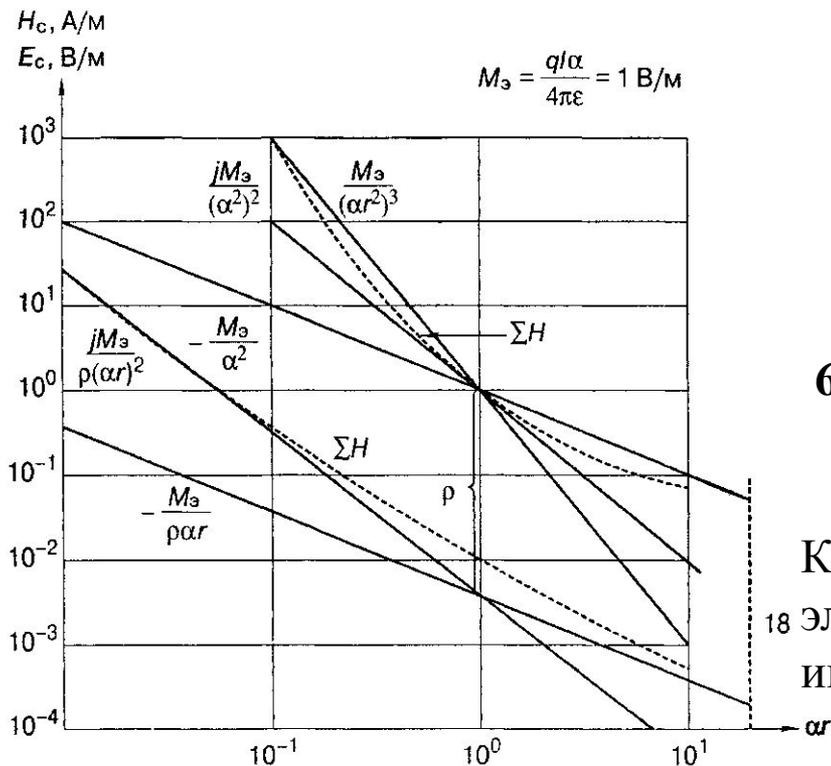
Рис 7. Составляющие поля элементарного электрического излучателя
