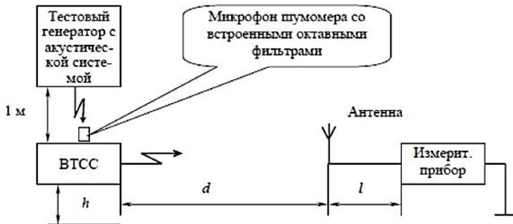
Рис. 6.5. Измерение побочных электромагнитных излучений ВТСС
