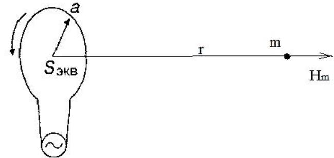
Рис. 11 Физическая модель излучателя магнитного поля
