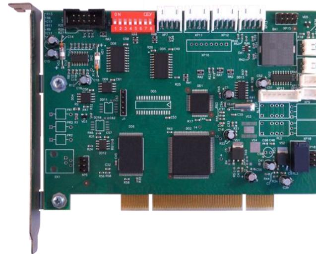
КРИПТОН-ЗАМОК/УМ (М-526В1) - модель, предназначенная для создания нескольких контуров безопасности и работы с модулями криптографической защиты информации.
