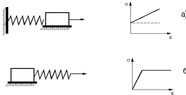
Виды упругопластических агрегатов
