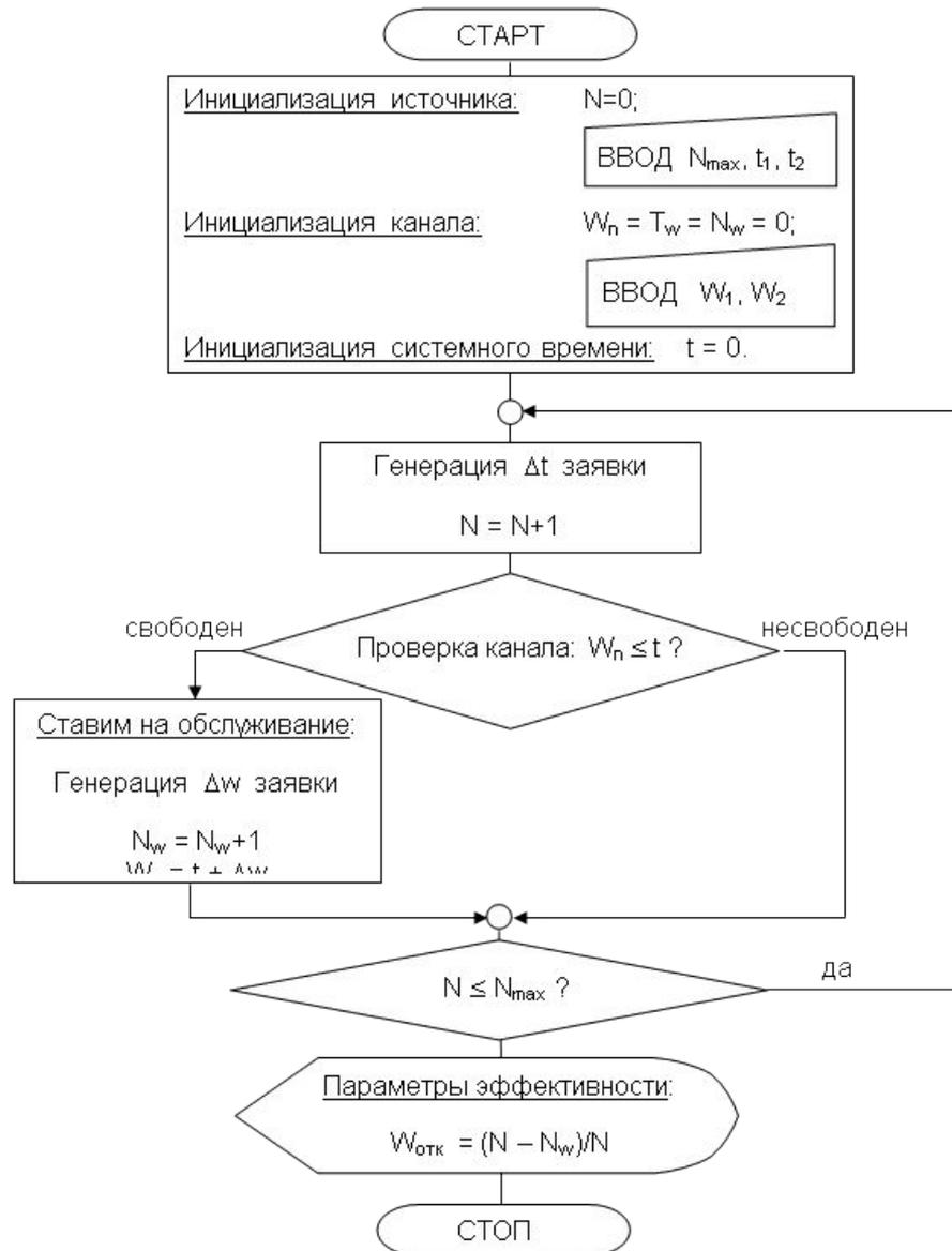
Рис. 7.2. Блок-схема имитатора
