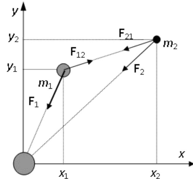
Рис. 4.13. Структурная схема системы двух тел в поле центральных сил
