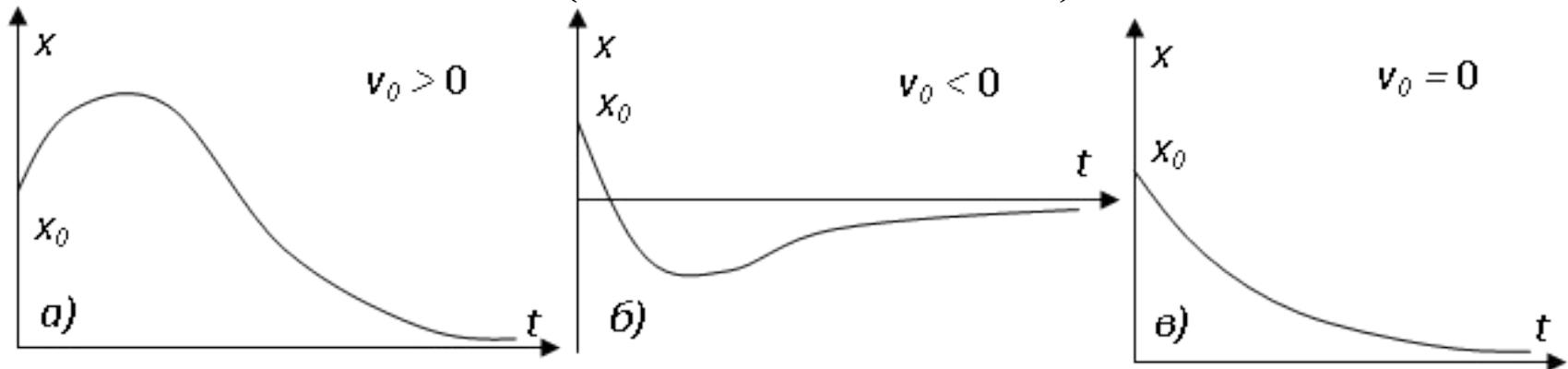
Рис. 3.25. Виды аperiodического движения при  $x_0 > 0$
