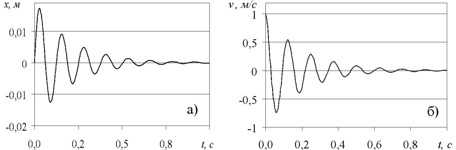
Рис. 3.23. Координата (а) и скорость (б) центра масс тела в вязкой среде
