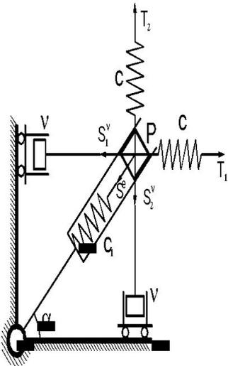
Двумерная структурная модель упругопластического упрочняющегося тела
