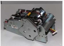
Принтер квитанций: печатает и выдает отчет о каждой транзакции по запросу держателя карты. Печатающая головка печатает непосредственно на термографической бумаге, поэтому лента для принтера не используется. Технология, используемая в термографическом принтере, позволяет печатать графику и расширенные наборы символов.
