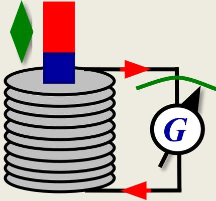
Переменное магнитное поле порождает особое **вихревое электрическое поле**, силовые линии которого замкнуты. Это поле двигает заряды в проводнике, создавая ЭДС индукции. В замкнутом проводнике возникает индукционный ток (рис).
