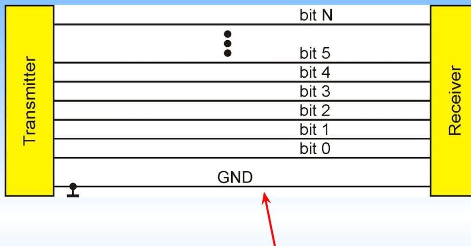
Нулевой провод или «земля» (GND – ground).
