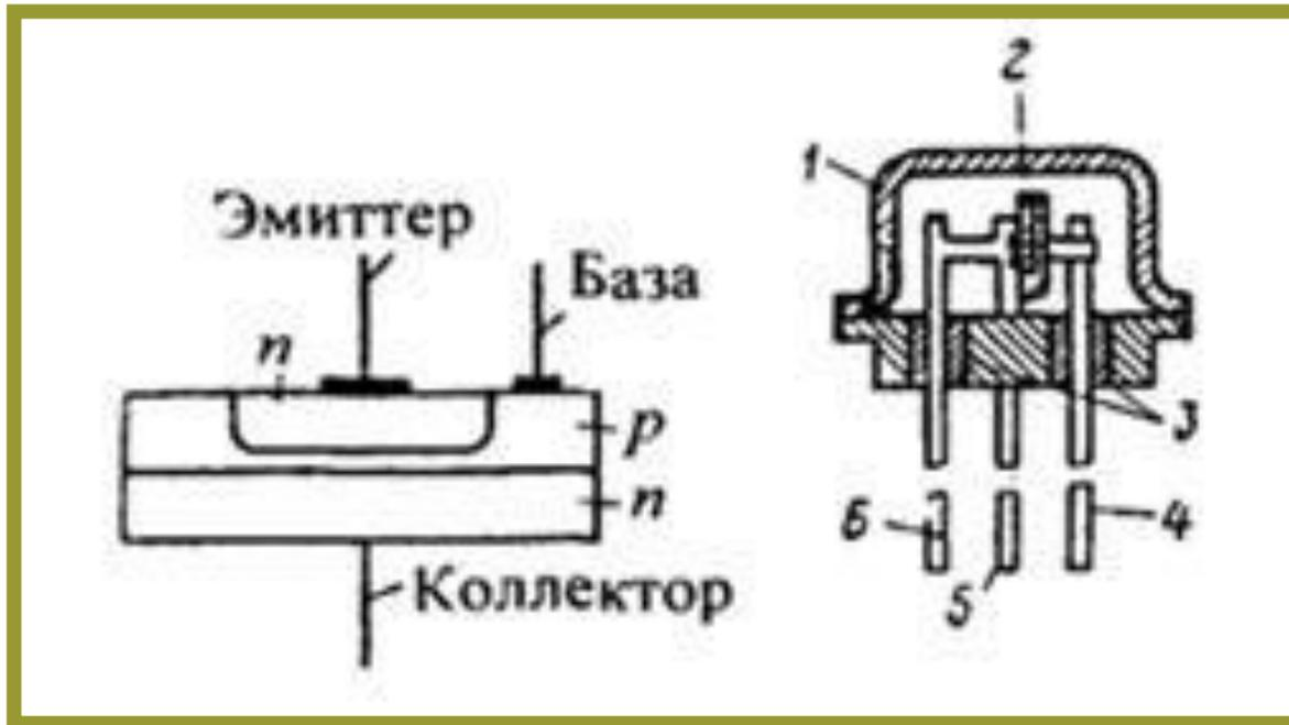
Структура и конструкция маломощного биполярного транзистора:
