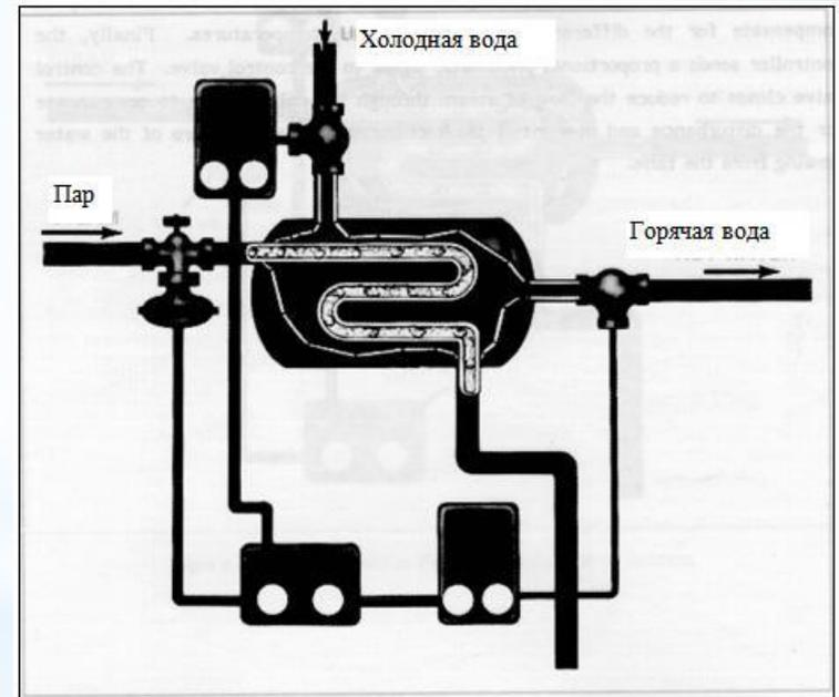
Рис. 6. Комбинированная система регулирования с обратной связью и воздействием по возмущению.
