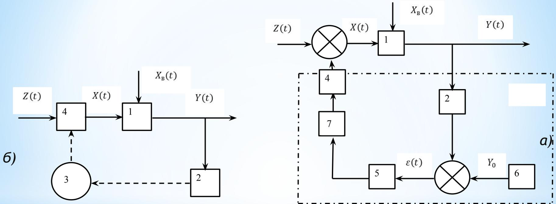
Рис.1.1. Системы ручного (а) и автоматического (б) регулирования:
