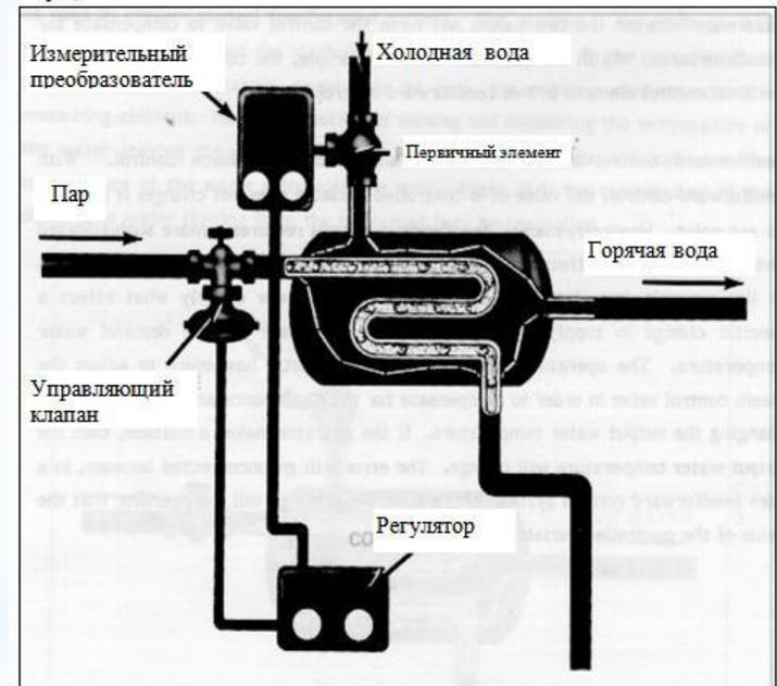
Рис.6. Автоматическая система регулирования с воздействием по возмущению
