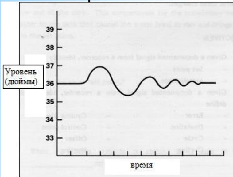
Рис. 1. Сигнал, представляющий изменение регулируемой переменной процесса
