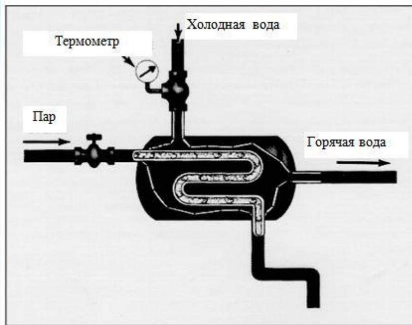
Рис. 5. Система ручного регулирования с воздействием по возмущению
