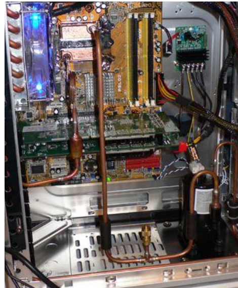
Система охлаждения с помощью фреона
