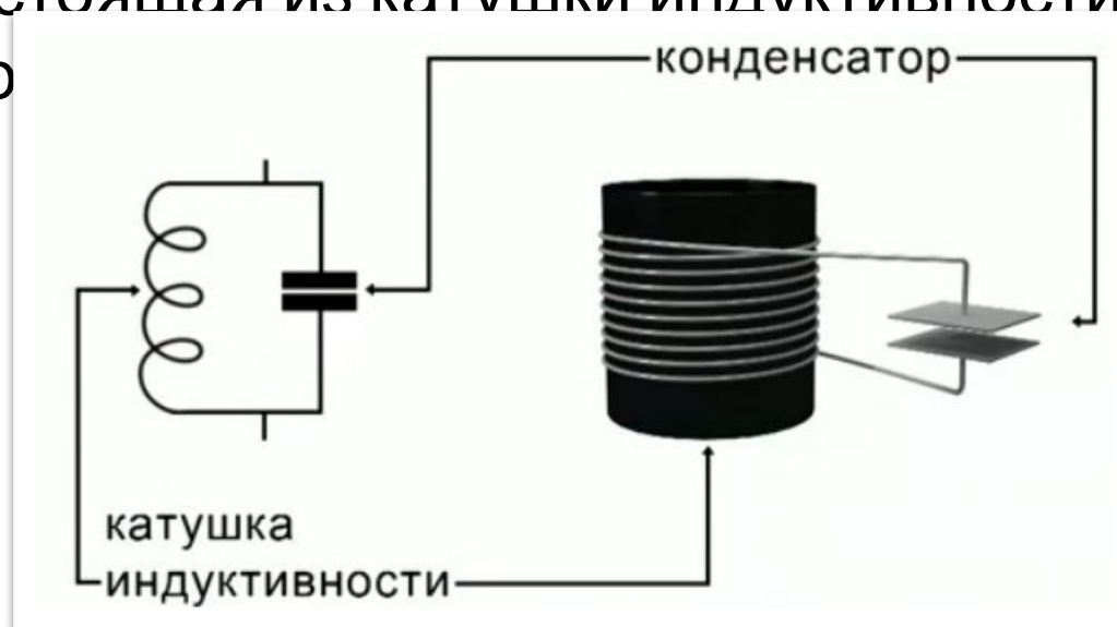
Рис. 1. Простейший колебательный контур
