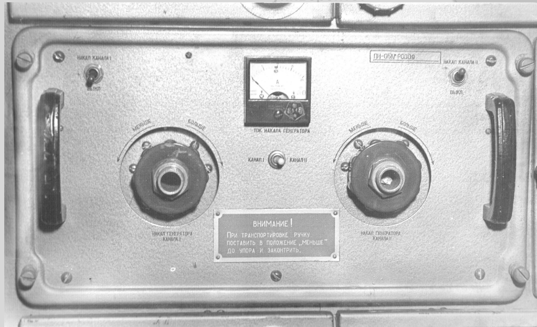
Блок накала магнетронов ПН-05
