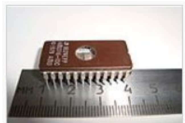
Микросхема ПЗУ AMD AM2716 выпущенная в 1979 году.
