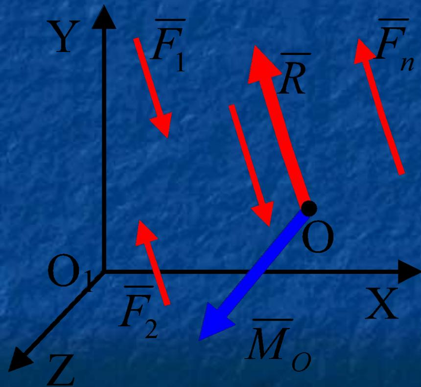
плоской системы параллельных сил.
