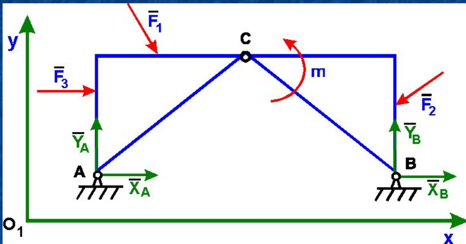
**Связи** между частями конструкции называются **внутренними (шарнир  $C$ )**, скрепляющие конструкцию с другими телами, - **внешними (шарниры  $A$  и  $B$ )**.
