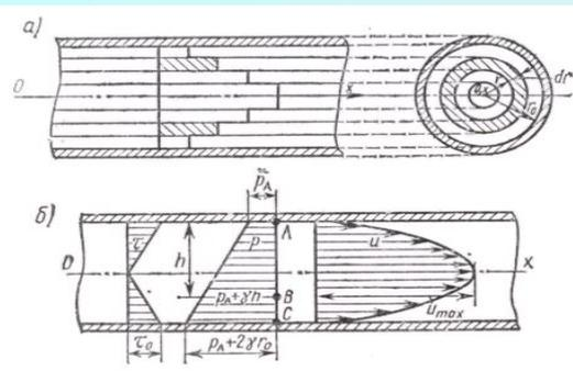
■ Турбулентный режим движения жидкости характеризуется беспорядочным движением частиц по произвольным траекториям и с различной скоростью, причем скорость в любой точке потока непрерывно изменяется как по величине, так и по направлению около некоторого среднего значения. Изменение во времени **мгновенной местной скорости** ( $u'$ ) называется пульсацией скорости.
