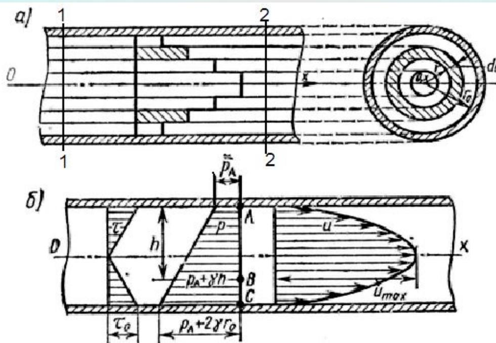
■ При равномерном движении жидкости все живые сечения по длине потока одинаковы как по форме, так и по размерам, и скорости в соответственных точках живых сечений также одинаковы. Таким образом, **скорость является функцией исключительно одного радиуса:**
