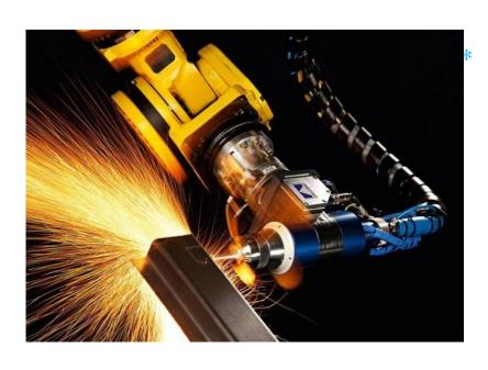
Производительность лазерной резки определяется скоростью резки и степенью автоматизации оборудования. В общем случае скорость лазерной резки составляет 1-9 м/мин (при толщине обрабатываемого металла 26-0,5мм соответственно). Максимальная скорость резки и максимальная толщина разрезаемого материала, как правило, пропорциональны выходной мощности лазера.
