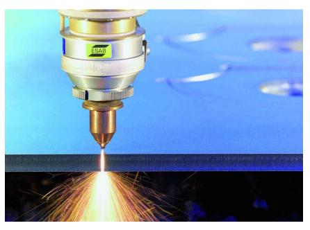
\* Данная лазерная технология стабилизирует процесс кислородной резки, несмотря на экспоненциальную зависимость скорости окисления металла от температуры. При этой лазерной технологии стенки реза гладкие. Глубина резания значительно возрастает по сравнению с использованием традиционной услуги – лазерной резки кислородом.
