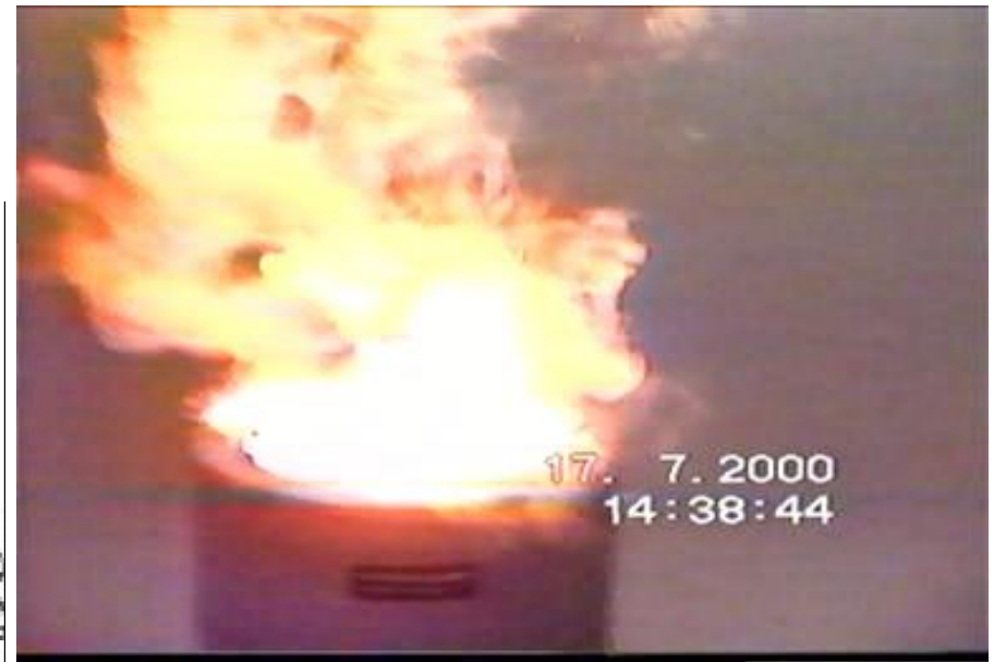
Рис.2 Взрывная реакция окисления нанокристаллического кремния
