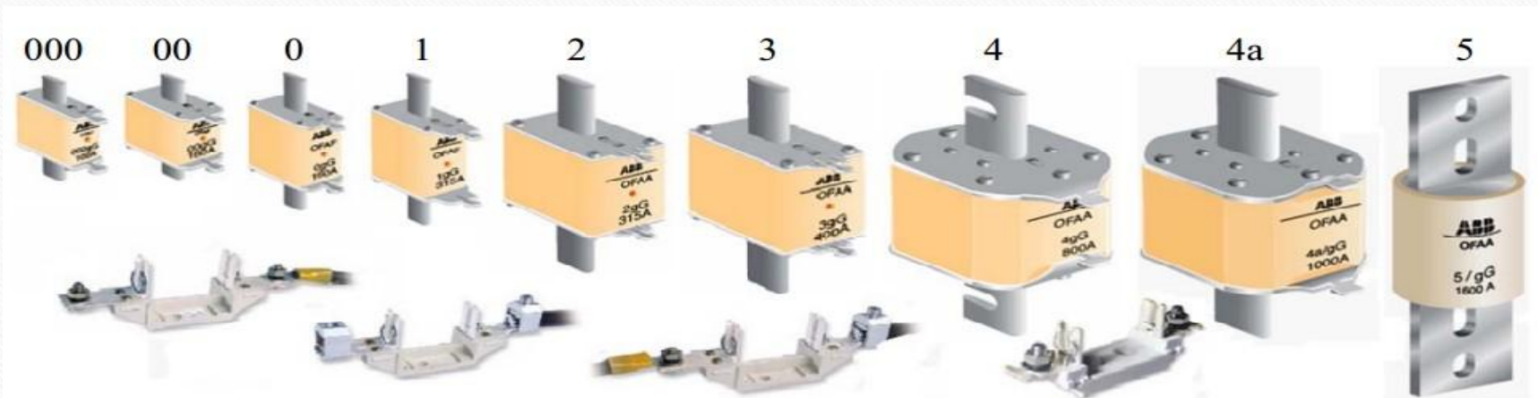
Рис. 4.4. Сучасні європейські запобіжники промислового призначення системи NH: вставки типорозмірів 000, 00, ... , 4а, 5 та ізоляційні основи з терміналами різних виконань (знизу) та різними можливостями приєднання зовнішніх провідників
