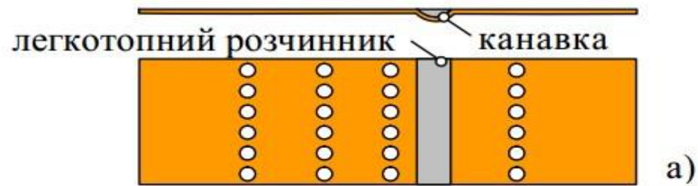
Рис. 4.5. Мідний топкий елемент з металургійним ефектом (а) та вплив металургійного ефекту на часо-струмові характеристики запобіжника (б)
