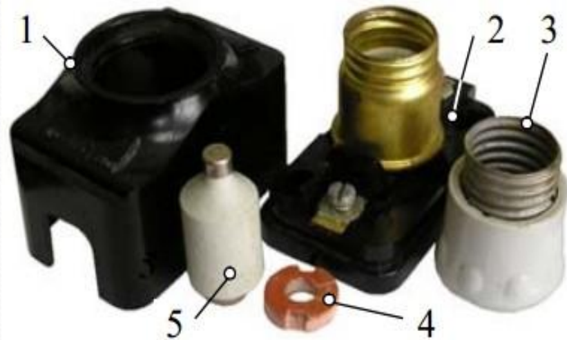
Рис. 4.1. Частини запобіжника ПРС: 1 – ізоляційна кришка; 2 – основа (fuse-base); 3 – тримач вставки (fuse-carrier); 4 – калібрувальна деталь (gauge-piece); 5 – вставка (fuse-link). До складу вставки входить топкий елемент (fuse-element), який розтоплюється при надструмах. Тримачем запобіжника (fuse-holder) називають поєднання основи та тримача вставки
