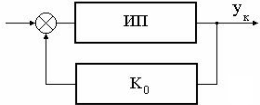
Приведенная погрешность ИП с замкнутой структурной схемой
