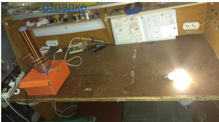
Тонким проводом (одним) передается электричество и на расстоянии зажигается люминисцентная лампа.
