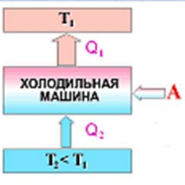
Процесс, обратный происходящему в тепловом двигателе, используется в *холодильной машине*. Системой за цикл от термостата с более низкой температурой  $T_2$  отбирается количество теплоты  $Q_2$  и отдается термостату с более высокой температурой  $T_1$  количество теплоты  $Q_1$ .
