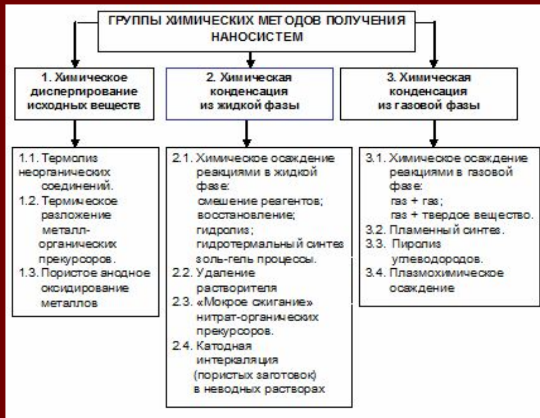
Рис. 1. Группы химических методов синтеза наносистем и пути их реализации
