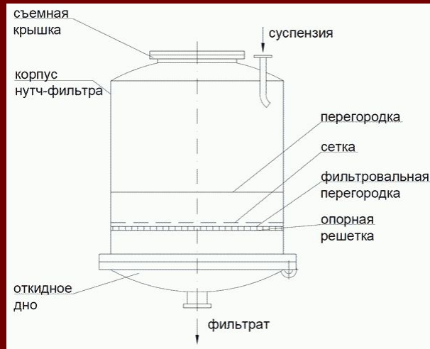
Рис. 10. Схема закрытого нутч-фильтра избыточного давления
