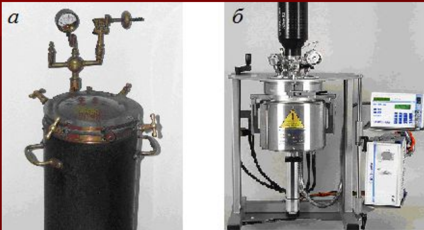
Рис. 5. Промышленный (а) и лабораторный (б) автоклавы для гидротермального синтеза с контрольно-измерительными приборами (для измерения и регулирования давления, температуры, уровня жидкости): а – реактор с диаметром до 2–3 м и высотой до 20 м; б – реактор из нержавеющей стали для работы под давлением до 60 атм и температуре до 250 °С объемом 1–5 л
