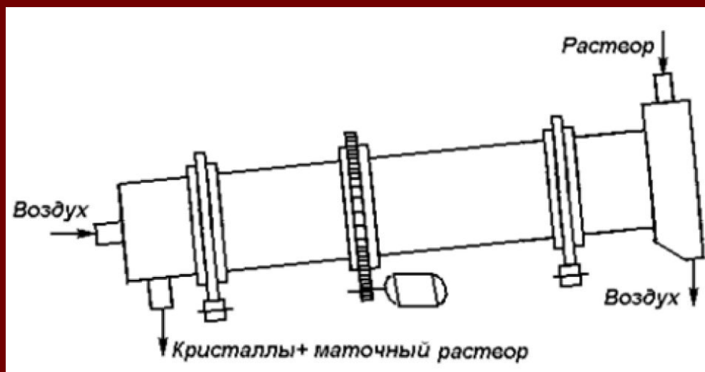
Рис. 9. Схема барабанного кристаллизатора с частичным испарением растворителя
