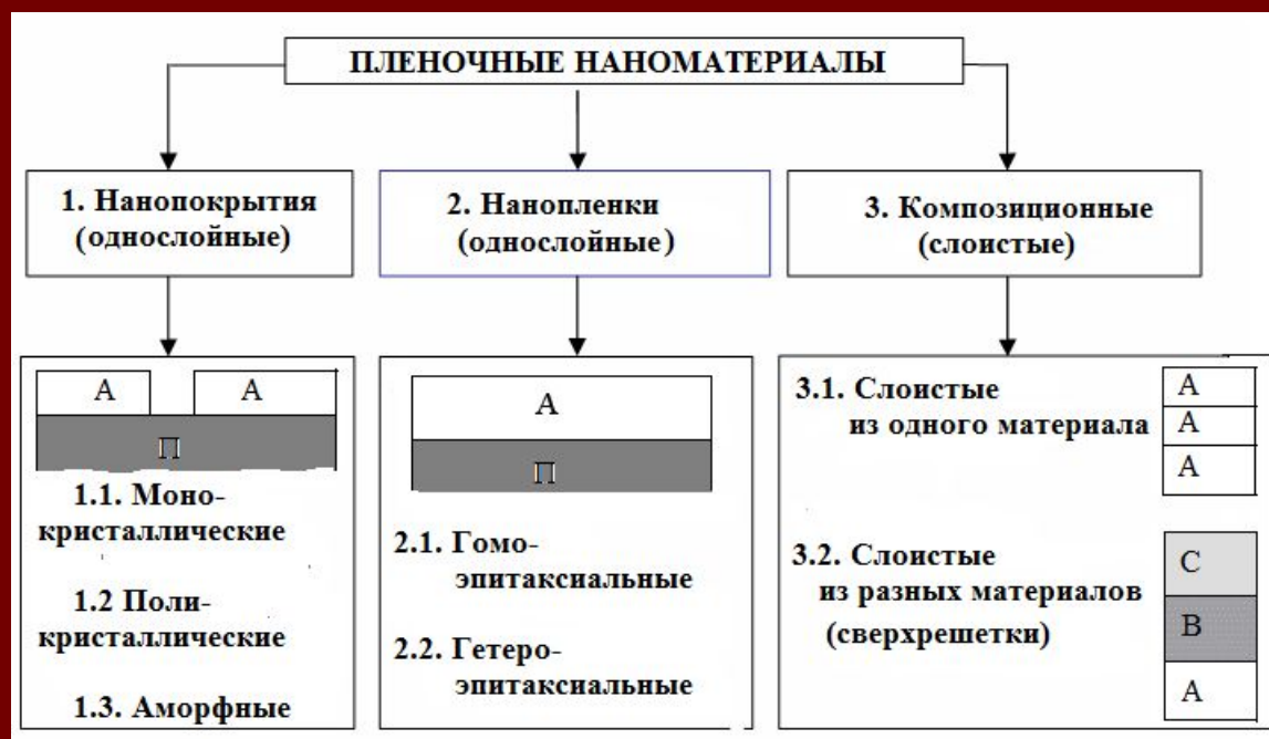
Рис. 1. Классификация пленочных наноматериалов по структуре
