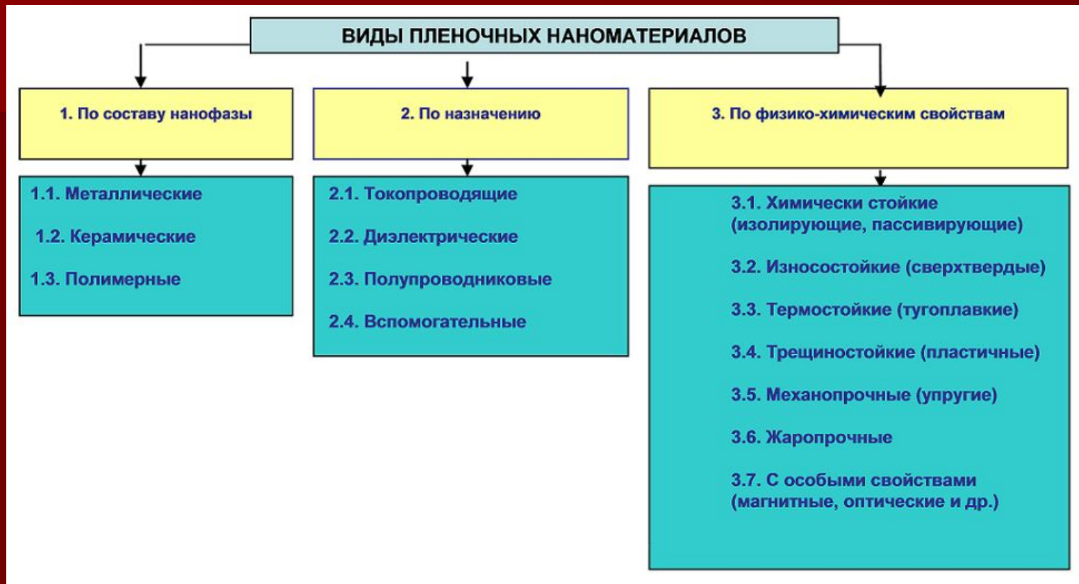
Рис. 3. Классификация пленочных наноматериалов по дополнительным признакам
