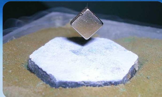
Отталкиваясь от неподвижного сверхпроводника, магнит всплывает сам и продолжает парить до тех пор, пока внешние условия не выведут сверхпроводник из сверхпроводящей фазы. В результате этого эффекта магнит, приближающийся к сверхпроводнику, «увидит» магнит обратной полярности точно такого же размера, что и вызывает левитацию (парение в пространстве).
