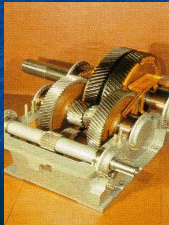
Редуктор для нефтекачалки
