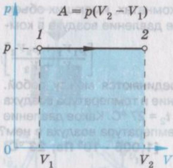
Работа, совершаемая газом при изобарном расширении ( $p = \text{const}$ ,  $m = \text{const}$ )
