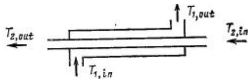
Рис. 1. Схема противоточного теплообменника
