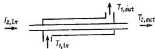
Рис. 2. Схема теплообменника с параллельным однонаправленным движением теплоносителей
