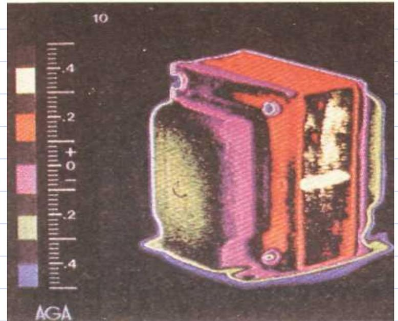
**Тепловизор откликается не на отраженные, а на испускаемые телами и предметами инфракрасные лучи, улавливая разницу температур в доли градуса различных участков поверхности, например человеческого лица или работающего трансформатора.**
