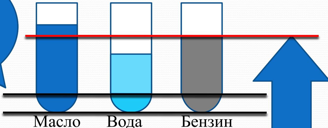
Следовательно у жидкости с минимальной плотностью должна быть максимальная высота
