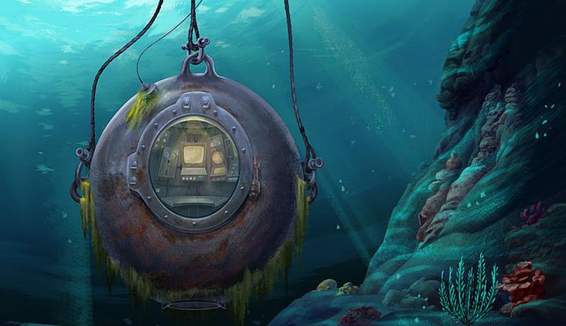
Для исследования моря на больших глубинах используют батисферы и батискафы. Батисфера имеет шарообразную форму и рассчитана на большие давления. Её опускают в море на стальном тросе со специального корабля.
