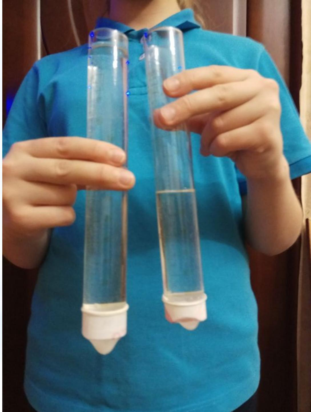
На этой фотографии изображены трубки с водой и «крепким» раствором соли. Видно, что уровни жидкостей находятся на одной и той же высоте, но давление на плёнку в правой трубке больше. Это объясняется тем, что плотность раствора соли больше, чем плотность обычной воды.
