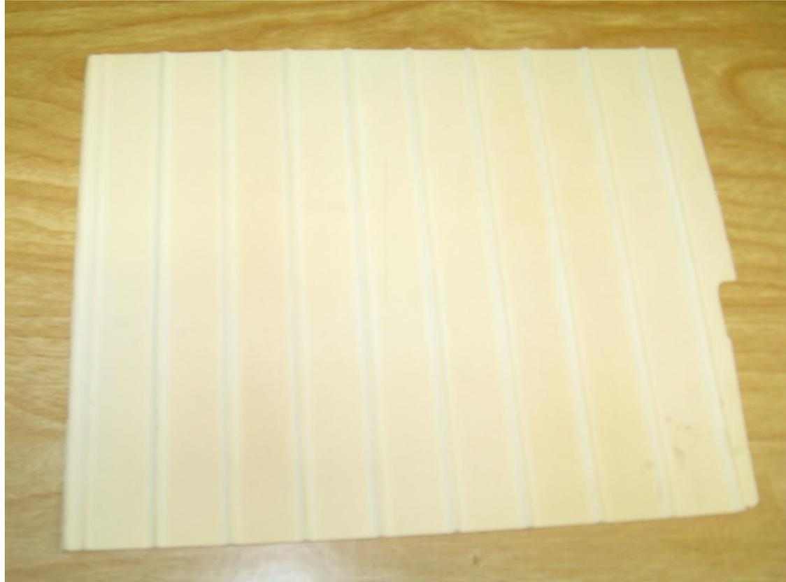
Один из применяемых сепараторов (мипласт). Выступами обращён к плюсу.
