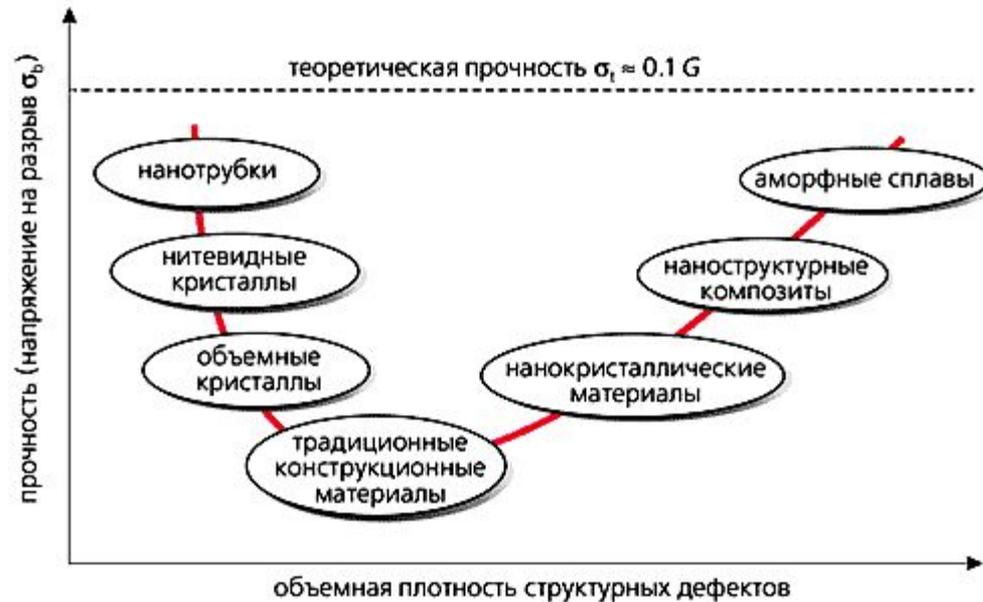
**Схематическая зависимость прочности от плотности атомарных дефектов в материале.
